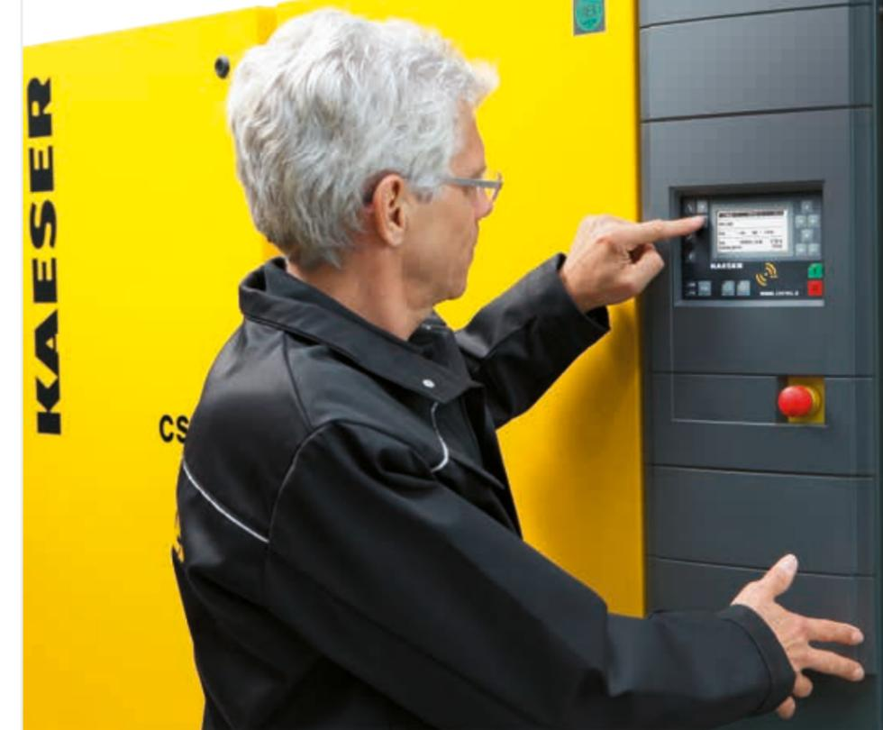
O comando interno do compressor SIGMA CONTROL 2 monitoriza e avalia todos os componentes relevantes e estados operacionais do sistema.
