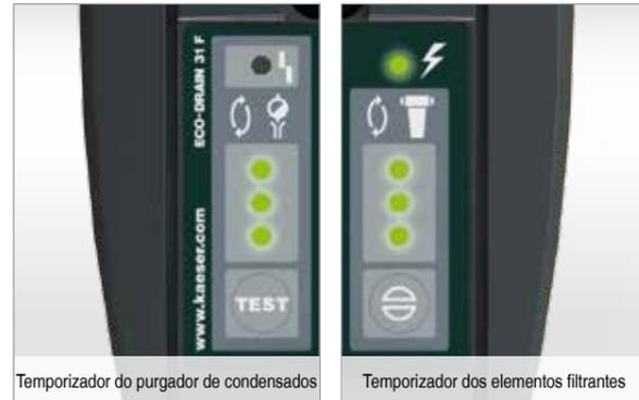
Temporizador do purgador de condensados
